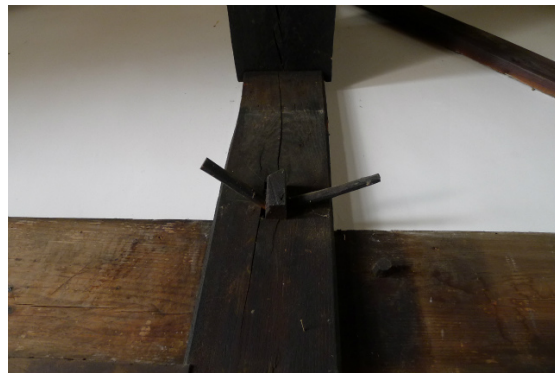
写真 4.7.4 鼻栓の曲げ降伏
