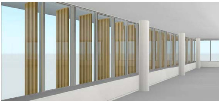
県産杉材による外部日除けルーバー
