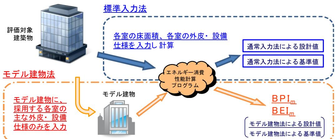
図 0-1-1 モデル建物法の概要
