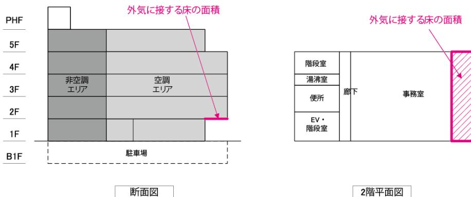
図 2-2-18 外気に接する床の面積の考え方
