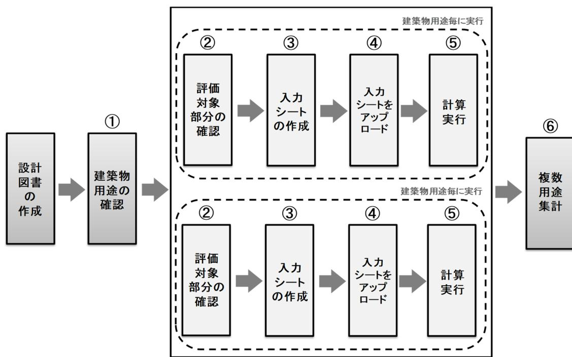
図 0-2-1 モデル建物法による評価の流れ
