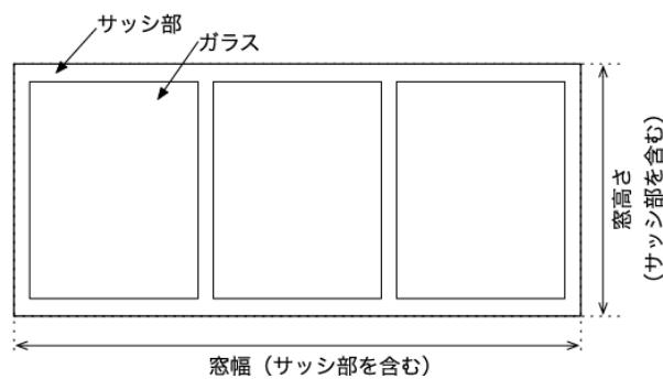
図 2-2-10 窓幅・窓高さの考え方
