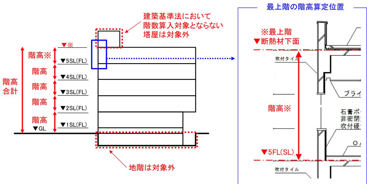
図 2-2-4 「各階の階高の合計」の算出方法
