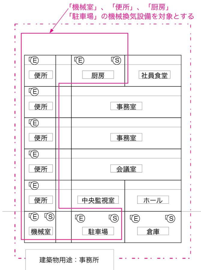
図 4-1-1 仕様を入力する機械換気設備の範囲（事務所モデルの例）
