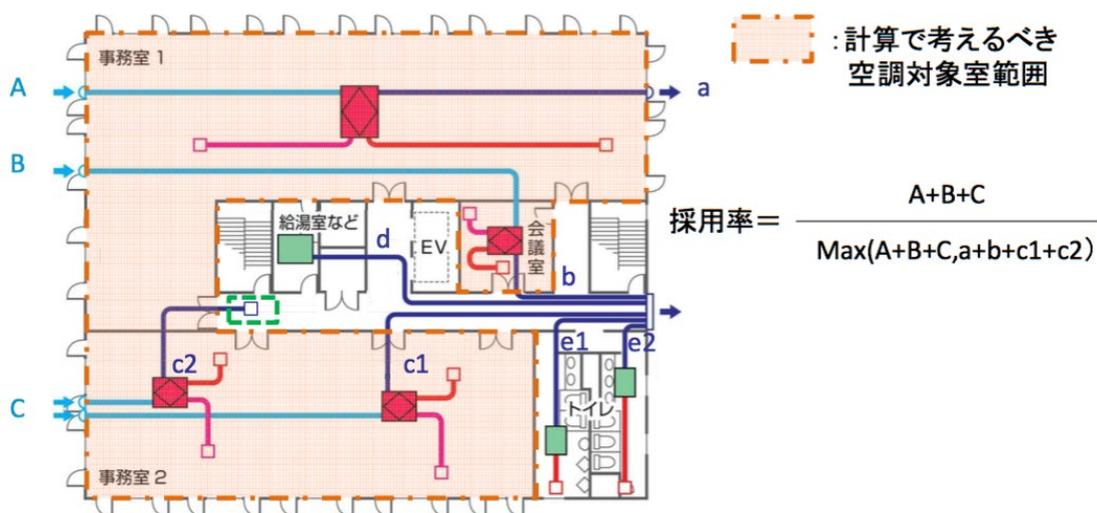
この場合、局所排気は、室内（廊下等）に落とした全熱交換器からの給気を排気するため、空調対象室の給排気バランスは崩れない。従って、この局所排気の換気量（d, e1, e2）は様式 C-2 に入力する必要はない。
