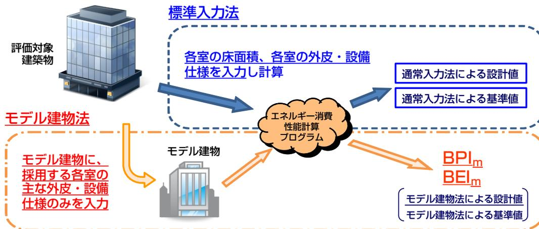
図 0-1-1 モデル建物法の概要
