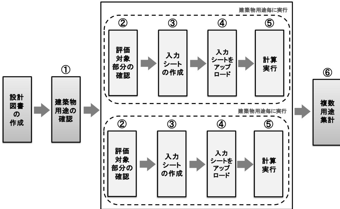
図 0-2-1 モデル建物法による評価の流れ
