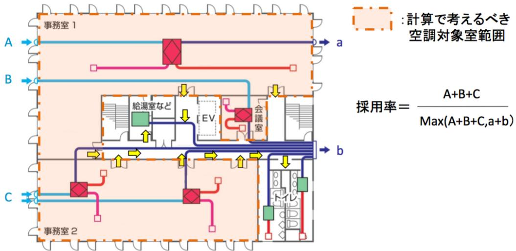
局所排気は空調対象室からの給気を排気するため、この局所排気は「空調対象室の給排気バランスに影響を与える給排気送風機」と見なされる。従って、この局所排気の換気量は様式 C-2 に入力する必要がある。
