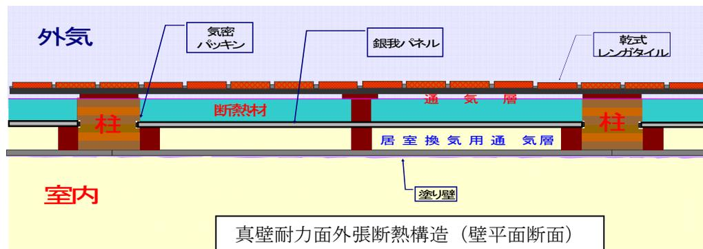
室内側の空間は、気密構造を気にする事なく配線、配管を自由に行う事ができると同時に、構造
