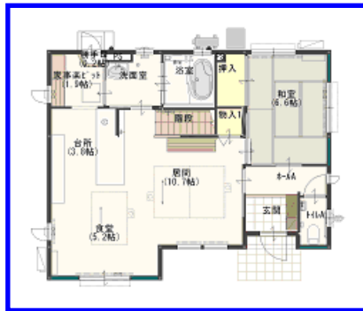
（図2）間仕切りには耐力壁をほとんど影響させずに耐震等級2を実現する。
