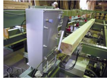
グレーディングマシンによる強度測定
