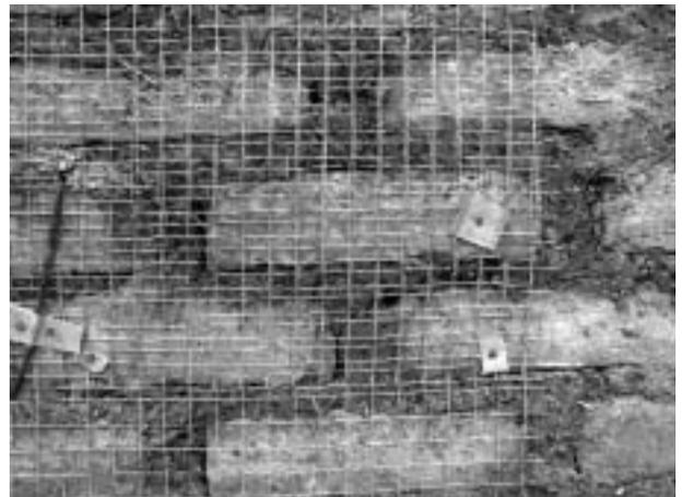
写真 18 カトリカ大学の実験施設で作成中のアドベ試験体
