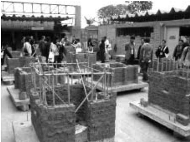
写真 17 カトリカ大学の実験施設で作成中のアドベ試験体
