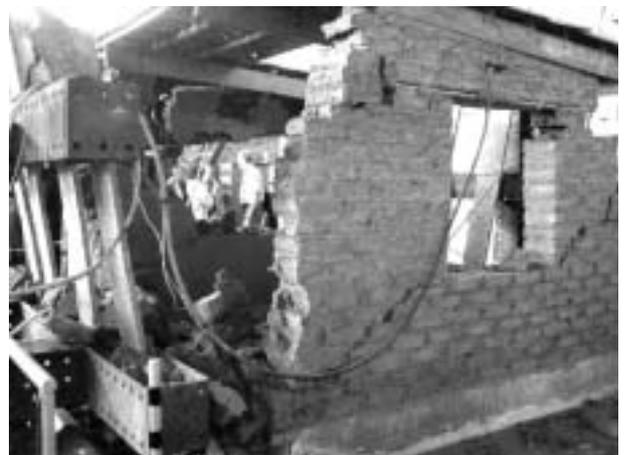
写真 21 カトリカ大学による振動台デモンストレーションの実大試験体 (無補強モデル) 振動により振動方向に対して面外の壁が大きく破損していることが分かる
