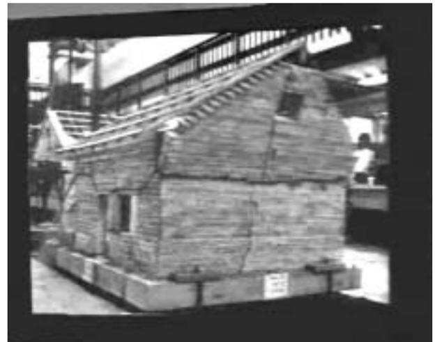
写真 12 振動台を用いたアドベ建築の実験の報告
