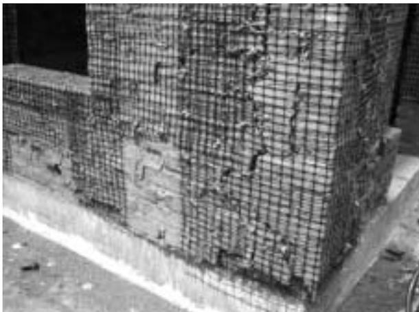
写真 23 カトリカ大学による振動台デモンストレーションの実大試験体（補強モデル）振動後の状況。壁体自体は相当ひどく破壊しているが、プラスチックメッシュにより倒壊を免れている状況が分かる
