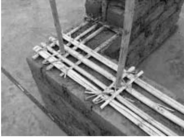
写真 16 カトリカ大学の実験施設で作成中のアドベ試験体
