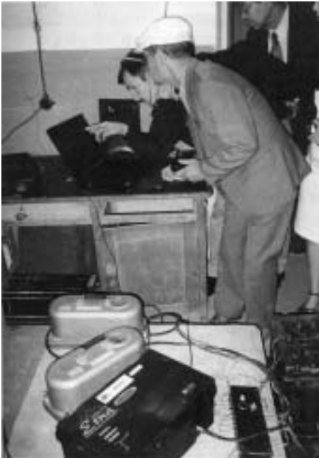
図 12 供与された強震計の設置状況（終了時評価報告書より引用）
