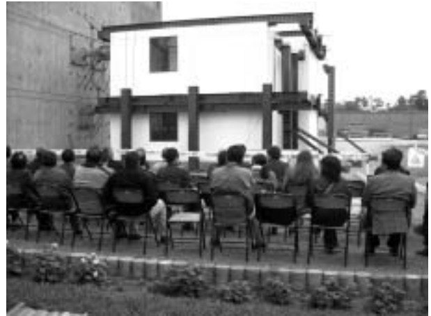
図 15 枠組みレンガ造住宅の実大構造実験
