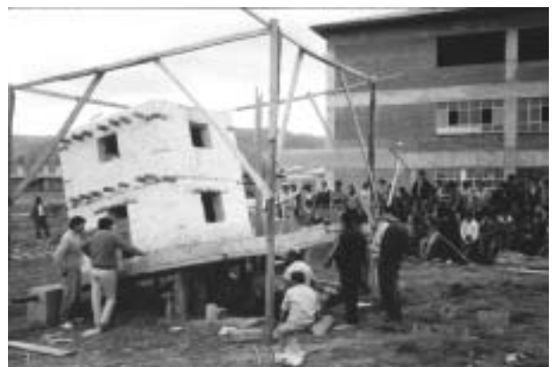
図 12 傾斜台を用いたアドベ住宅の構造実験（クスコ大学）
