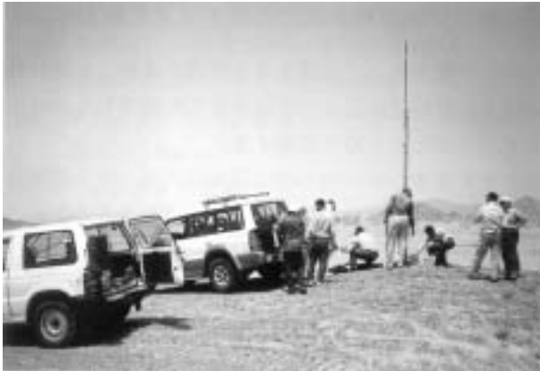
写真 5 臨時地震観測点。無線信号受信アンテナの設置（参考文献12より）
