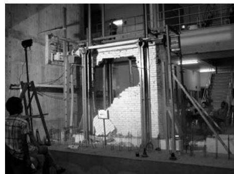
図 2 繰り返し水平加力実験の実施状況
