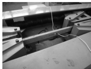
図 2 引張試験を実施している様子
