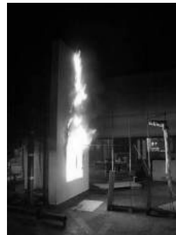
図 6 外断熱工法試験体の燃焼性状
