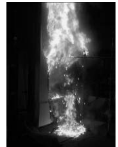
図 7 EPS 試験体の燃焼性状
