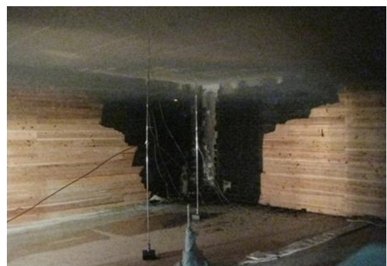
写真 3 煙突効果がシャフト空間の火炎性状に及ぼす影響に関する模型実験（シャフト下端の火源付近の開口の大きさや発熱速度等を変化させた）
