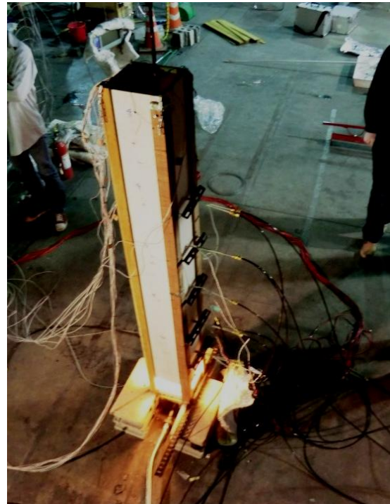
写真 3 煙突効果がシャフト空間の火炎性状に及ぼす影響に関する模型実験（シャフト下端の火源付近の開口の大きさや発熱速度等を変化させた）
