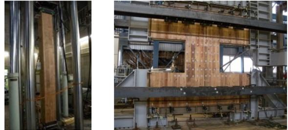
図1 座屈試験(左)と面内せん断試験(右)
