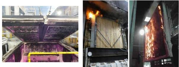
図4 炭化速度測定試験(左)と壁の載荷加熱試験(右)の様子
