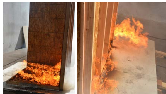
図 5 OSB ボードへの着火と燃え抜け
