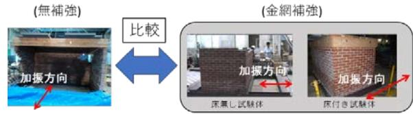
図 4 組積造壁の振動台実験。無補強の壁と金網補強を施した壁の振動特性を比較。床は地震力を加振方向の壁に分配させる効果を生じ耐震補強効果を高める。
