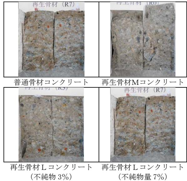
写真1 再生骨材中の不純物
