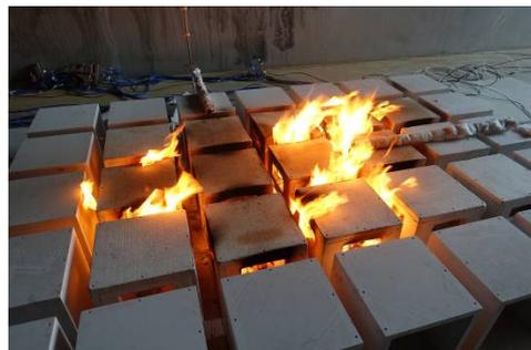
写真 1 縮小模型による市街地延焼実験 (1/20 スケール)
