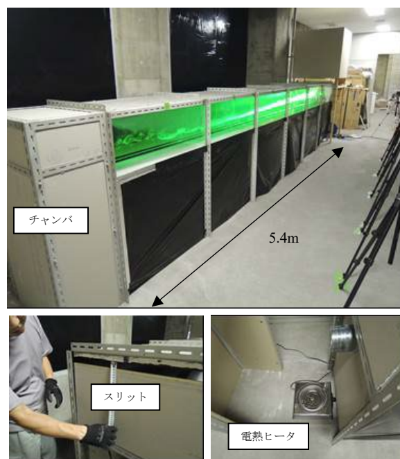
写真1 煙流動に関する模型実験の様子
