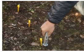
写真3 山中式土壤硬度計
