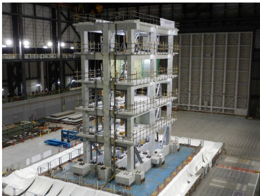
写真1 震動実験の様子
