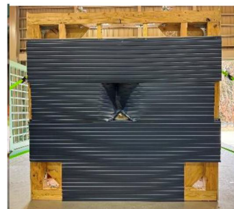
図4 有風時の破壊性状
