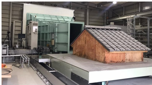
図1 実大強風雨発生装置の外観
