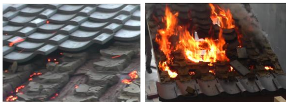
写真1 再現実験: 火の粉の着床と飛び火による炎上
