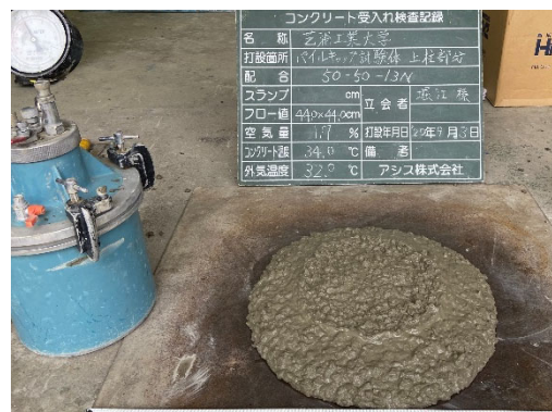
写真 4.2.2-4 柱 コンクリート受入れ調査記録 (打設日 2020 年 9 月 3 日)
