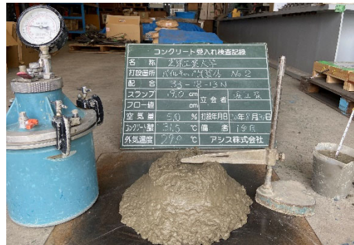
写真 4.2.2-2 E-2 パイルキャップ、梁 コンクリート受入れ調査記録 (打設日 2020 年 8 月 31 日)
