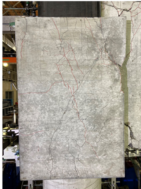
写真・図 4.3.1-2 E-2 最終破壊形態および Q-R 関係
