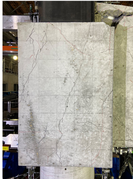
写真・図 4.3.1-1 E-1 最終破壊形態および Q-R 関係
