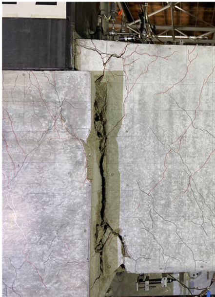
写真・図 4.3.1-2 E-2 最終破壊形態および Q-R 関係
