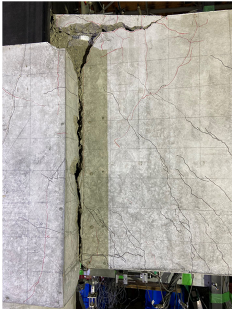
写真・図 4.3.1-1 E-1 最終破壊形態および Q-R 関係
