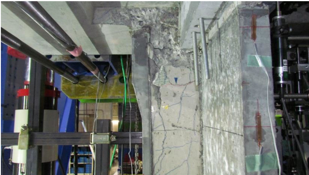
(i) 1C1 柱袖壁接合部最終破壊形状
