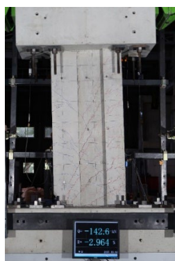
写真 1.3-5 せいの短い壁の実験
