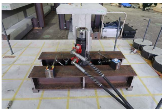
写真 1.3-3 実験棟でのアンカー実験
