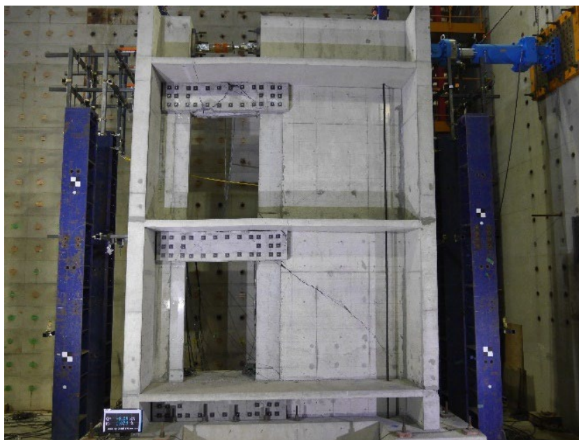
写真 1.3-8 新設開口を設けた 2.5 層実大壁式架構の構造実験
