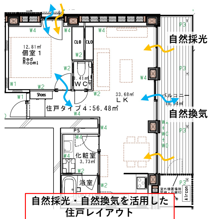
図 2.3.5 自然採光・自然換気を活用した住宅のエネルギー消費量削減
