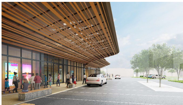
木調ルーバーを用いた大庇
