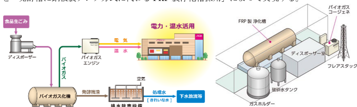
図 2.2.71 オンサイト型のバイオガス発電設備
