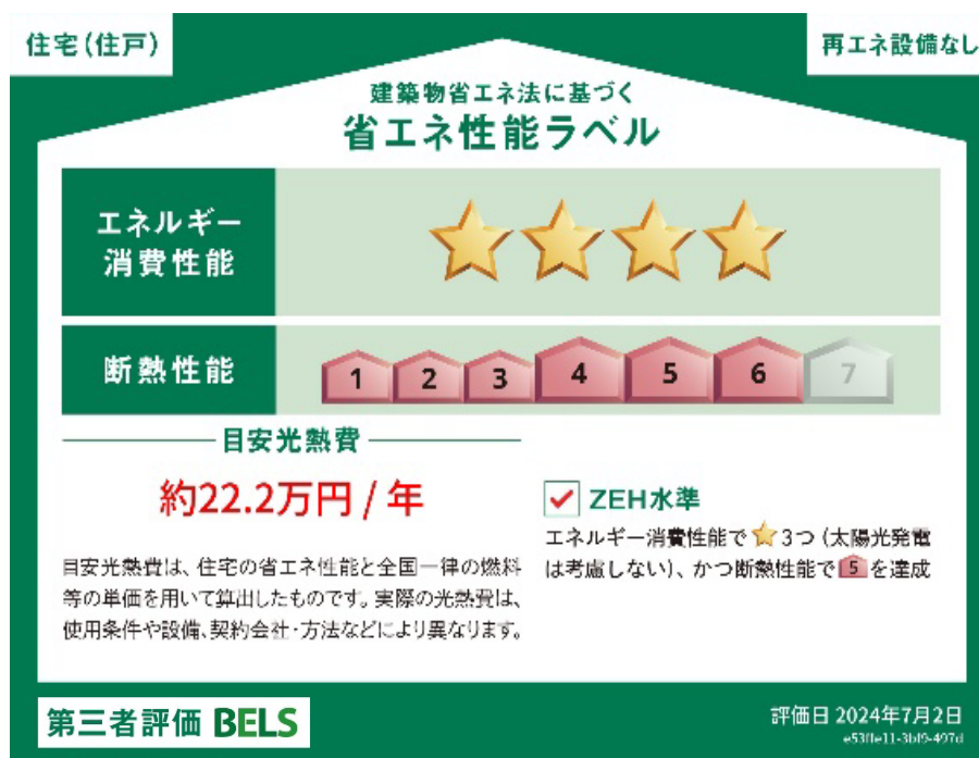
図 2.3.4 ZEH 水準を上回る断熱・省エネ改修と省エネ性能ラベル
