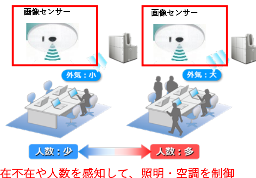
図 2. 2. 43 画像センサーで在室状況を検知する照明・空調制御
