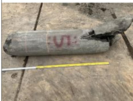
折損部の杭体の様子
