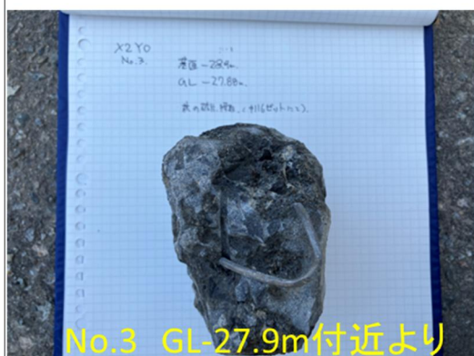
図 3.1.4-14 杭頭部付近の損傷状態 (X2Y0)
