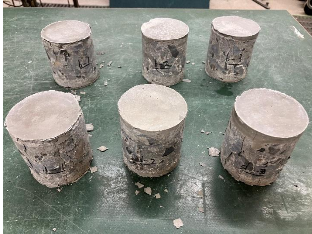
写真 3. 4. 1-4 試験後のコンクリート供試体
