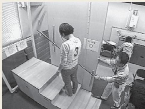
写真4 被験者を用いた手すり高さの実験
