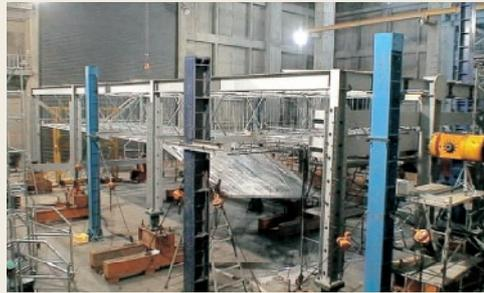
写真3 天井の脱落に関する実験
