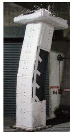
写真6 耐火被覆を25%剥ぎ取った実験後の試験体
