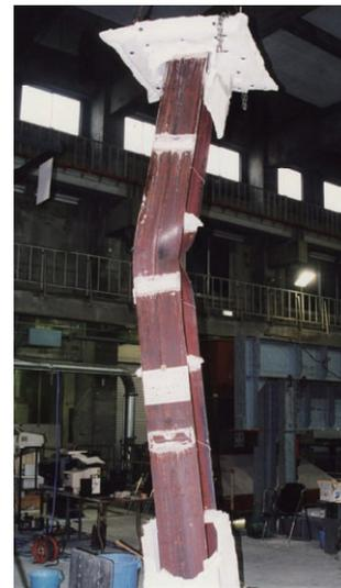
写真5 載荷加熱試験後の大きく変形した鉄骨柱
