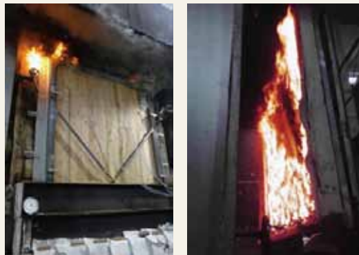
CLTパネル壁の荷重加熱試験の非加熱面(左)と加熱面の様子(右)
