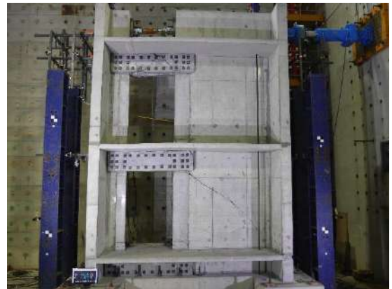
図2 開口と補強(開口の周囲)を施した実大壁の実験
