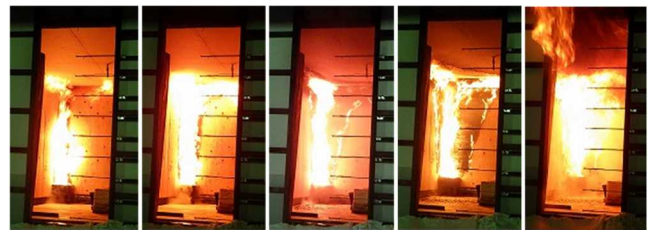
写真 木質内装室内の火災進展状況 (右端が FO 発生)
