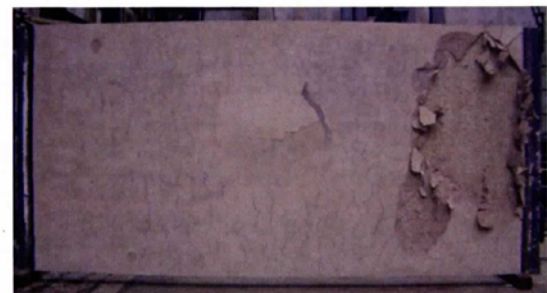
写真3 No.6(PCM20mm, ワイヤ)実験後の状況
