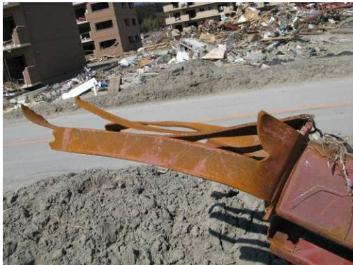
写真 6. 4. 2-5 引き裂かれた梁フランジ (陸前高田市)
