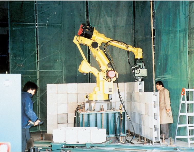
19. エレクトロニクス利用による建設技術高度化システムの開発 ブロックの組積を自動で行うロボット Development of systems for upgrading building technology through the use of electronics Robots automatically collect and assemble blocks.
