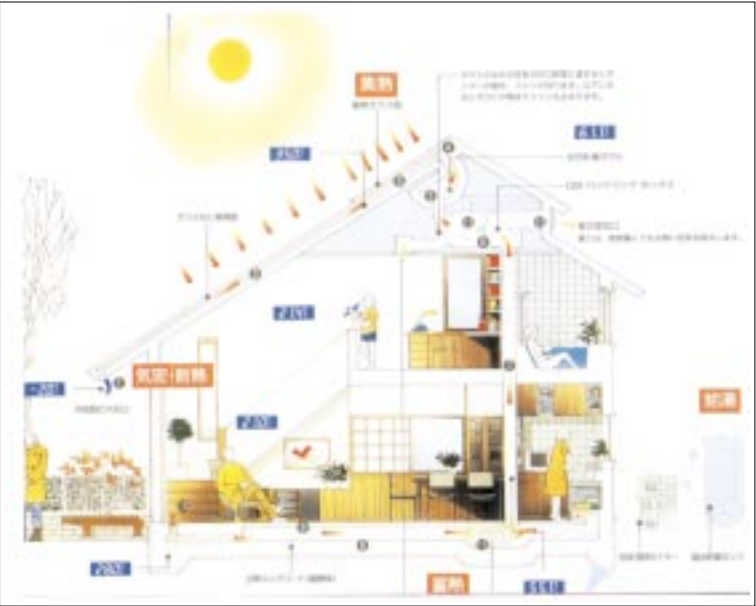
10. 省エネルギー住宅システムの開発 太陽熱の効率的利用により省エネルギー化を図ったパッシブ・ソーラー・ハウスのイメージ図 Development of energy-saving housing systems Artist's conception of passive solar house designed to save energy by efficiently using the sun's heat.
