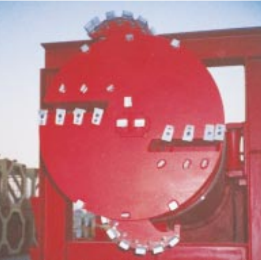
24. 地下空間の利用技術の開発 楕円断面の掘削が可能なシールド Development of underground space utilization technology This shield can be used to excavate an elliptical section.
