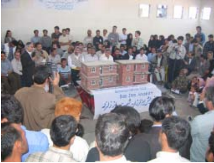
写真1 一般市民向けの振動台の実演。バム（イラン）における伝統的な住宅を忠実に再現した模型と耐震補強をした模型を同時に振動させた。
