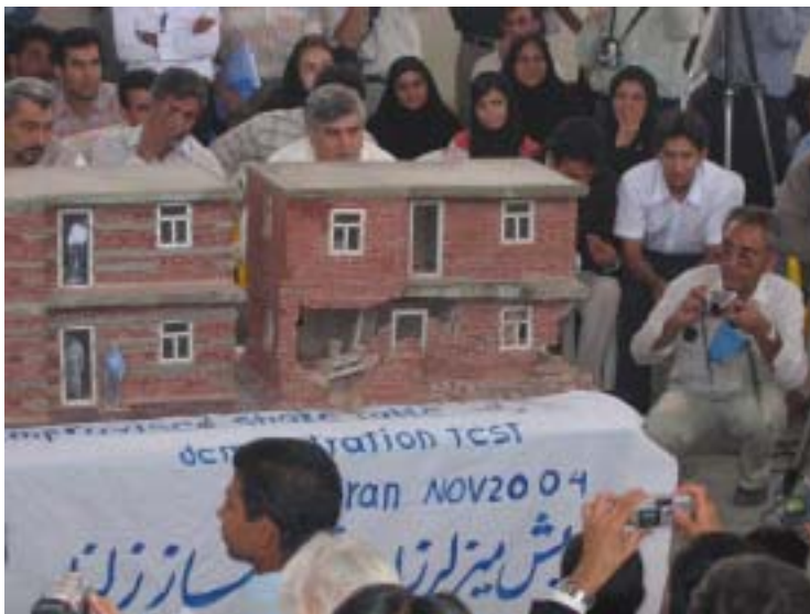
写真2 2棟を同時に振動させている状況。伝統的な工法のものには被害が生じているが、補強されたものには生じていない。
