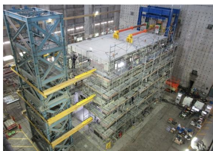
地震時の損傷低減を目的としたRC実大3層架構の載荷実験～大地震後の建築物の継続使用のための耐震レジリエンス性能の評価～
