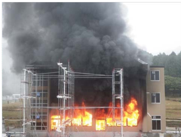
【写真2】2階教室に延焼 (*再着火から63分後)
