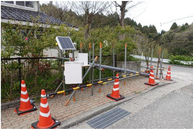
図 5.2.4 地盤変位のモニタリング
