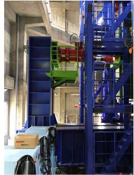
試験装置後方（面外水平ジャッキ2台）
