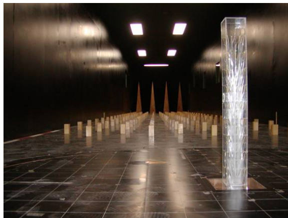
超高層建築物模型の風圧実験の様子
