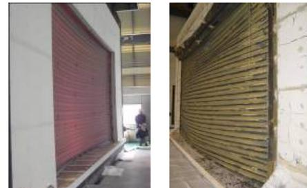
図3 大開口防火シャッターの加熱試験
