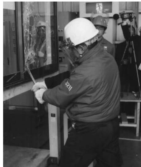
写真4-1 防犯性能試験で一定の防犯性能があると評価された建物部品が目録に掲載される。（警察庁提供）
